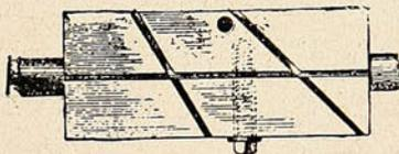
de los tubos. En dicha pieza se abren, en las máquinas de serrar, unas ranuras en ángulos diversos, según los cortes que se necesiten hacer, y además se abre otra ranura paralela a la perforación que permite sujetar primeramente el tubo por medio del tornillo que se ve en el dibujo. De este modo el trabajo se hace con toda comodidad bien a máquina, bien a mano.
