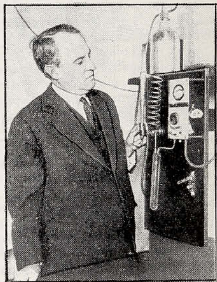
Es sabido que el gas que sale del escape de un automóvil es venenoso y ha habido numerosos casos mortales. Mr. Hutchinson, colaborador del célebre inventor Edison, ha ideado un dispositivo para quitar el veneno al monóxido de carbono transformándolo en un gas completamente inofensivo.
