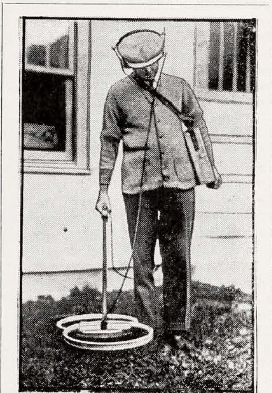
Un sistema moderno para encontrar tesoros por medio de un aparato de radio. Con el radio se puede establecer la existencia de cualquier clase de metal en la tierra. El aparato es tan sensible que oscila hasta con una moneda de plata enterrada a treinta centímetros.
