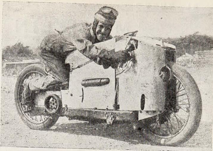
Máquina, diseñada para carrera, que alcanzó recientemente a batir un récord de velocidad. Alcanzó a desarrollar 240 kilómetros por hora. Máquina de cuatro cilindros que participó en la carrera de Brooklands Inglaterra, piloteada por G. Tucker. Desarrolla 80 caballos y está conceptuada como un verdadero monstruo en su clase.
