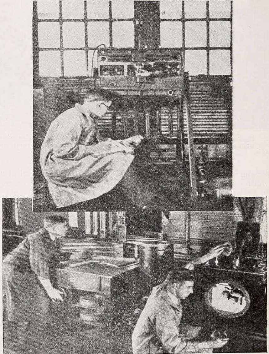
El funcionamiento del carburador se determina no tan solo haciéndolo funcionar en un motor, sino estudiándolo en una caja sellada herméticamente con Mercurio. ¿Recibirán todos los cilindros cantidades iguales de combustible? En este aparato se estudia la distribución de la mezcla y su recorrido por la tubería de admisión.
