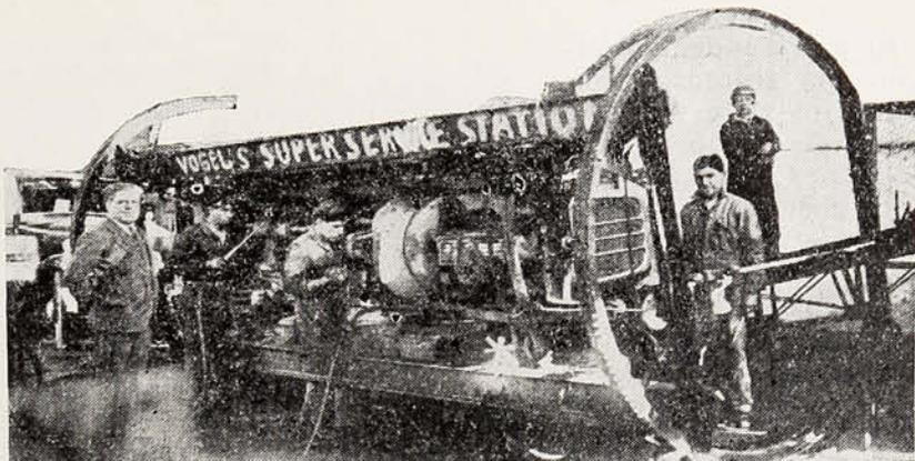
El aparato llamado autogiro que permite inclinar lateralmente un automóvil para revisar la parte inferior del chasis.
