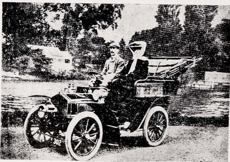
El primer Rolls vendido. Un 10 H. P. dos cilindros construido en 1904
