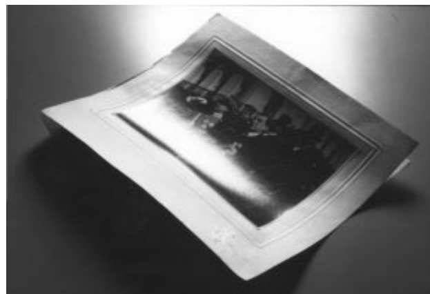
Abarquillamiento de una fotografía por cambios de temperatura y humedad relativa
