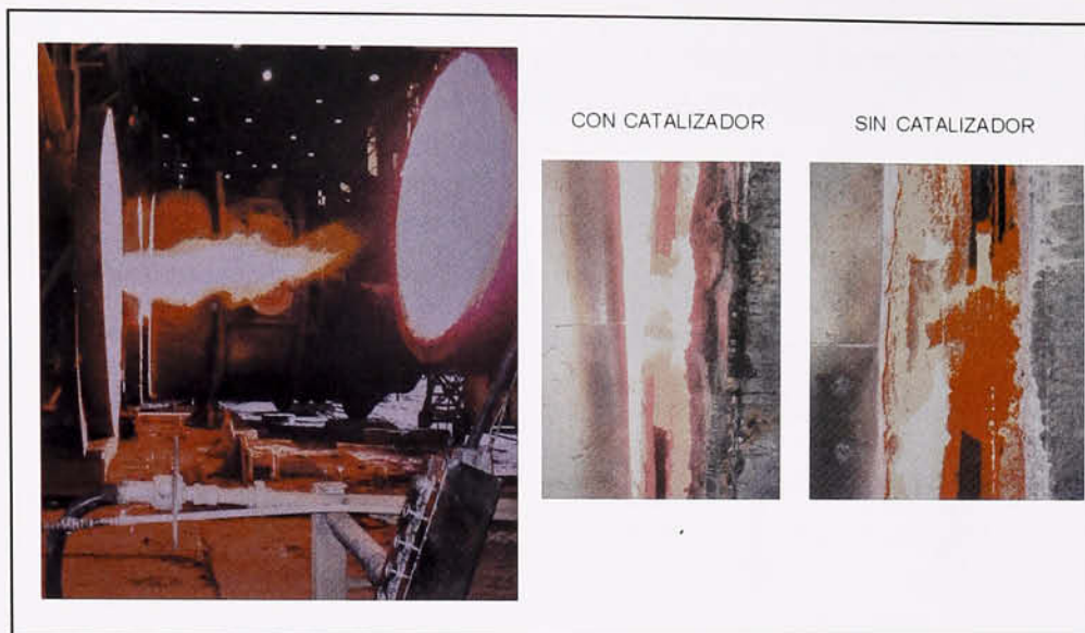
Fig. 3: Calentador de cucharas. Llamas sin y con catalizador.
