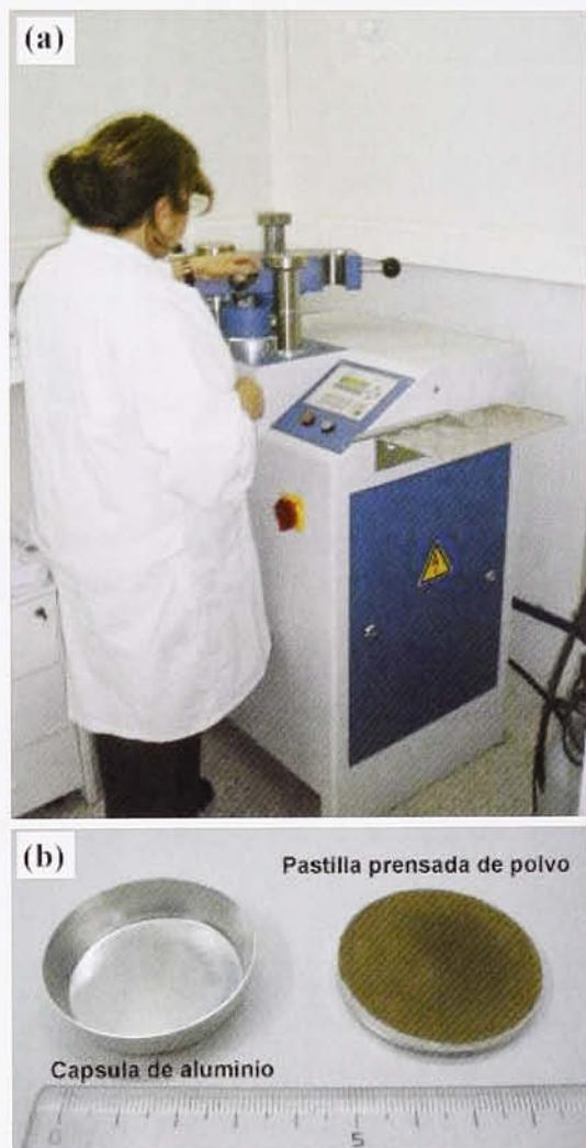
fig 3: (a) HTP40, Prensa hidráulica HERZOG. (b) Capsula de Aluminio y pastilla prensada de polvo. Las pastillas prensadas de polvo se preparan colocando una mezcla de 2,7 g de muestra con 0,3 g de cera sobre ácido bórico en un recipiente de aluminio. Luego se pone en la prensa hidráulica HTP40 y se aplica una presión de 300 kN por un tiempo de 5,0 segundos.
