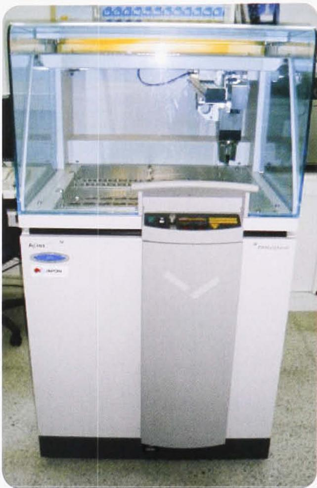
Fig.1: Fotografía del espectrómetro de fluorescencia de Rayos X PANalytical Axios.
