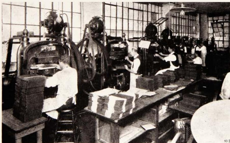
91- Máquinas litográficas para impresiones a color
