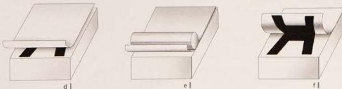
70 | Esquema de impresión litográfica: a) Se dibuja el motivo. b) Se limpia la superficie con agua para sacar lo no deseado. c) Con un rodillo entintado, se cubre la superficie de la piedra, quedando visible lo que se desea reproducir. d) Se coloca un papel sobre la superficie entintada. e) Se presiona la superficie con un rodillo. f) Se obtiene la impresión reversa.
