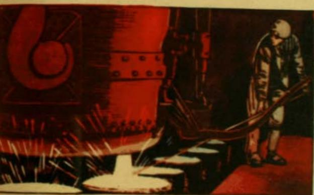
Obrero dejando caer acero líquido en moldes. El acero se obtiene del hierro por medio de un procedimiento especial llamado Bessemer, nombre del ingeniero inglés que lo inventó. El acero es un metal blanco y brillante.
