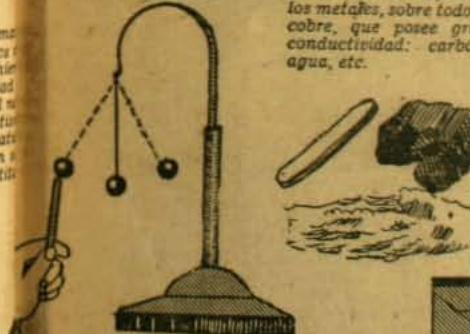
Pendulo eléctrico. Si frotamos una varilla de vidrio y la aproximamos a la bolita de azúcar (A), la atraerá (B), pero una vez que haya tocado la varilla retrocederá (C) porque ha tomado ya parte de la electricidad de la varilla, y dos electricidades iguales se rechazan.
