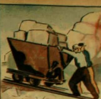
3. Después de cortados los trozos se cargan en vagones que van sobre rieles, y que transportan el mármol hasta el próximo sitio de embarque.
