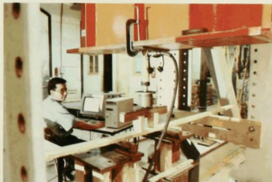
*Laboratorio de Estructuras. Área Madera.* Indica la resistencia de las vigas y su nivel de deformación.
