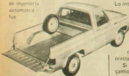
concentrado para que usted tenga una total, auténtica camioneta y no un vehículo híbrido, diseñado mitad auto y mitad camioneta. La "Campeona" nació camioneta y así se comporta. La caja tiene siete travesaños en su base, otorgándole una rigidez extraordinaria. Sus secciones vienen ancladas con pernos de fácil reparación y reemplazo.
