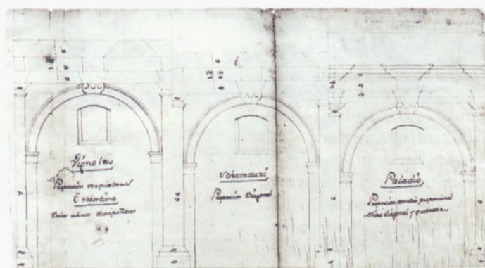
Propuesta para la altura de los arcos de la catedral, según las proporciones dadas por Vignola, Scamozzi y Paladio, 1753. Archivo Nacional, Santiago.
