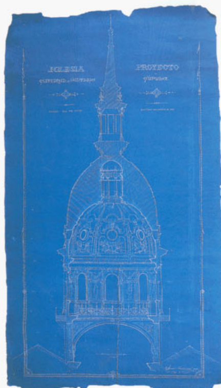
Ignacio Cremonesi: Corte de la cúpula de la catedral de Santiago; se puede apreciar la solución de las cubiertas de las naves laterales, a dos aguas. Copia en papel azul, 8 de octubre de 1900. Archivo de la Catedral.
