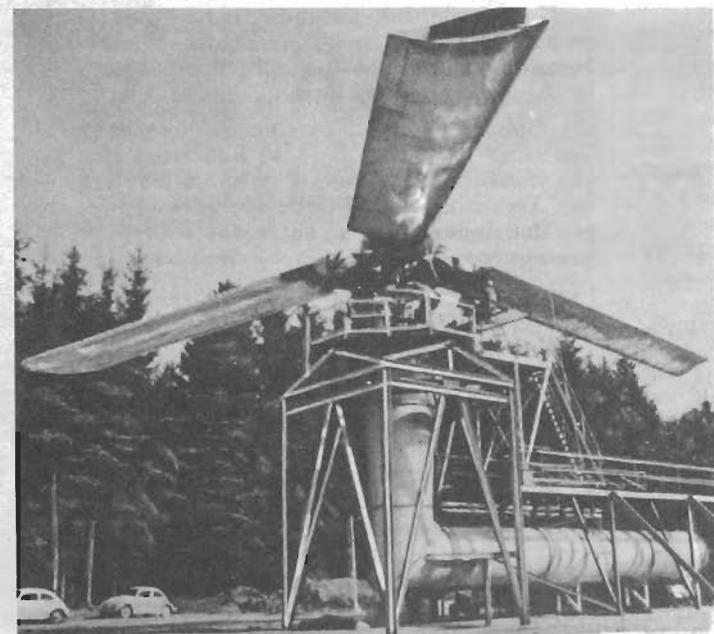
*Un monstruo de tres patas, cada una de las cuales mide 15 metros de largo. Este rotor de helicóptero es el primero en el mundo que ha logrado desarrollar una fuerza de sustentación de 36.000 kilogramos, que duplica la de los rotores actuales. El turborreactor de 18.000 H.P. utilizado para la alimentación de aire comprimido, lanza una mezcla de gases de eyección calientes y de aire comprimido frío. Su inventor es el profesor alemán Herdelberg*
