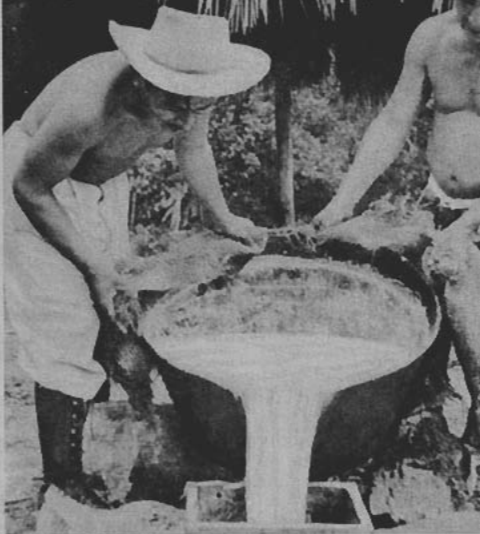
Una vez que el látex adquiere la consistencia deseada se le vierte en moldes de madera, donde se enfría y forma panes que son llevados al mercado
