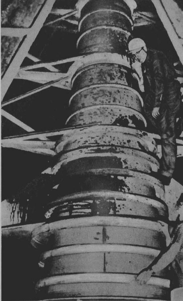
Esta perforadora del proyecto norteamericano "Mohole" está destinada a las grandes perforaciones que se llevarán a efecto a fin de analizar la estructura de la corteza terrestre en un espesor de 25.000 metros, por lo menos
